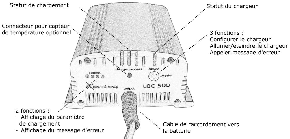
Le LBC 500S est un chargeur de batterie et chargeur de maintien entièrement automatique qui peut dès lors rester connecté en permanence au réseau électrique et à la batterie. Le microprocesseur contrôle en continu la batterie et le processus de chargement de manière à garantir un processus de chargement sûr et précis. L'électronique interne découle des développements les plus modernes qui ont permis la conception d'un chargeur particulièrement intelligent.
