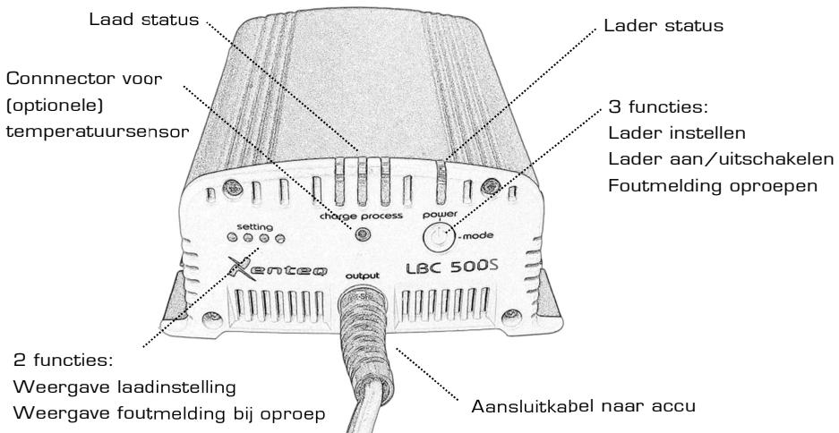
De LBC 500S is een volledig automatische acculader en druppellader in één en kan daarom permanent aan de netspanning en aan de accu aangesloten blijven. De microprocessor controleert continu de accu en het laadproces zodat een zeer veilig en nauwkeurig laadproces gewaarborgd wordt. De interne elektronica is voortgekomen uit de modernste ontwikkelingen waardoor een bijzonder intelligente lader is ontstaan.
