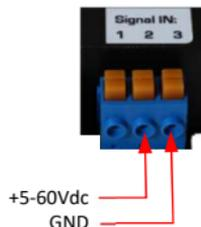
Fällt das externe Signal aus, wird der Inverter ausgeschaltet.
