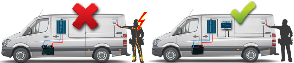
Einsatzsituation des Isolationswächters
